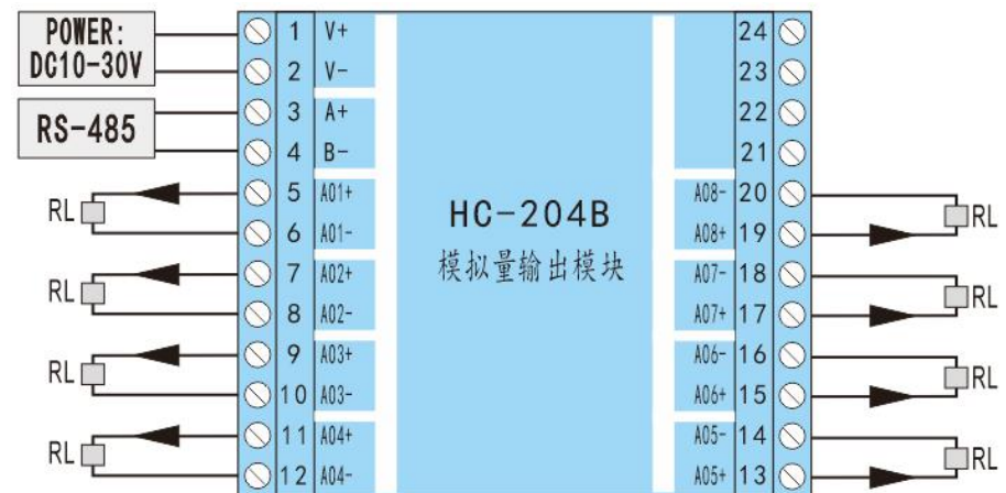
HC-204B 模拟量输出模块典型接线示意图
