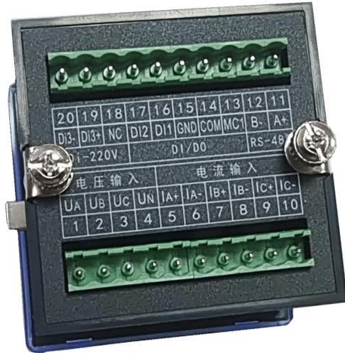
安装：采用面板嵌入式，67mm×67mm 开孔安装；卸下左右 2 个安装卡子，将仪表推入盘面安装开孔内，再将 2 个安装卡子从后边的沟槽装上并拧紧，固定好仪表。
